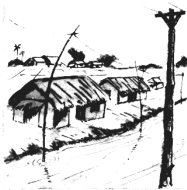
Hình 1.5. Không dùng các loại cây tre, trúc, gỗ mục để làm cột điện.
